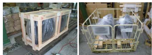
改善前の木箱包装(ワンウェイ) (左)と改善後の通い箱(折りたたみ式コンテナ)
