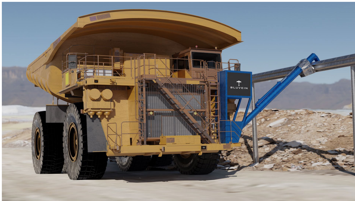
露天採掘現場における大型車両用充電システム BluVeinXL(イメージ)
